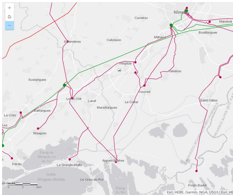
Figure 12 : Cartographie du réseau de transport d'électricité géré par RTE sur le territoire de Petite Camargue 3
