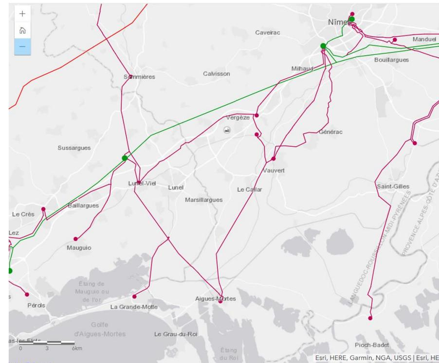
Figure 12 : Cartographie du réseau de transport d'électricité géré par RTE sur le territoire de Petite Camargue<sup>3</sup>
